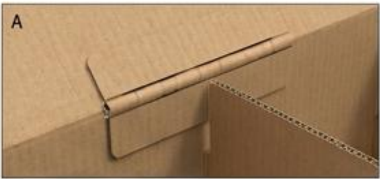
A: LIVING HINGE DETAIL CERNIERA INTEGRATA NEL CARTONE PER PIEGATURA RIPETUTA SENZA ROTTURA
